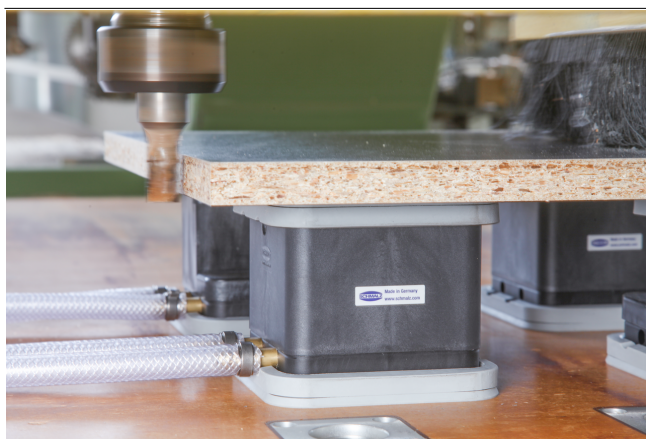
Blocksauger VCBL-G-K2 beim Aufspannen einer Spanplatte
