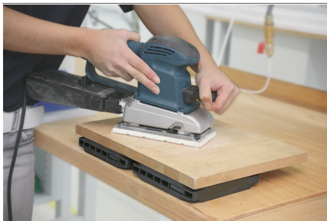
Multi-Clamp Saugplatte VC-M-SP bei der manuellen Bearbeitung eines Holzwerkstücks
