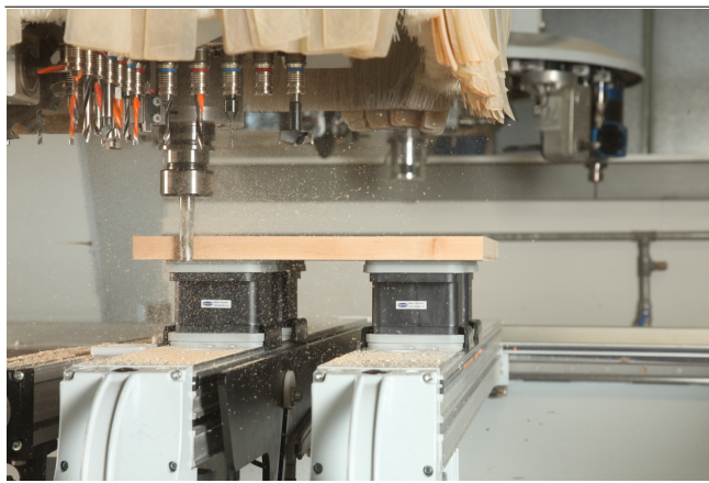
Blocksauger VCBL-K1-PRO beim Aufspannen von Massivholz
