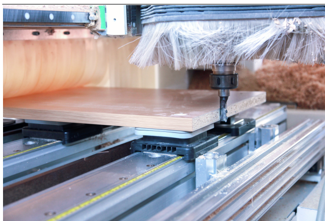
Blocksauger VCBL-S beim Einsatz auf SCM-Konsolen
