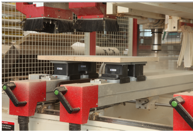
Blocksauger VCBL-K2 beim Aufspannen eines Werkstücks
