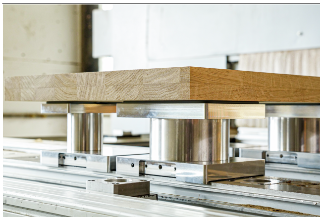
Blocksauger VCBL-K2-HD beim Aufspannen von Massivholz
