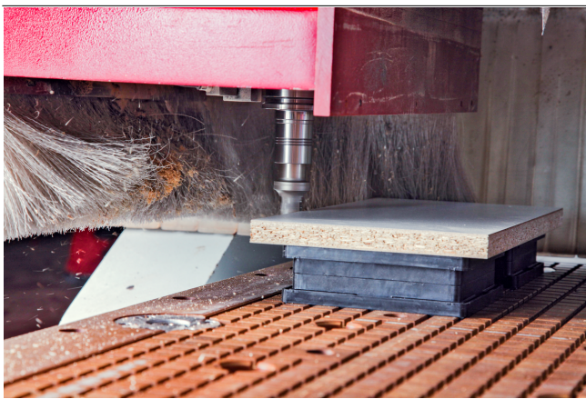
Blocksauger VCBL-R beim Aufspannen einer Spanplatte
