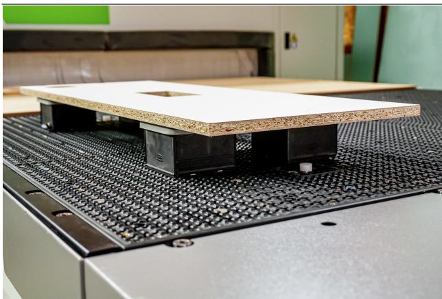
Blocksauger VCBL-R Redesign beim Aufspannen von flächigem Werkstück
