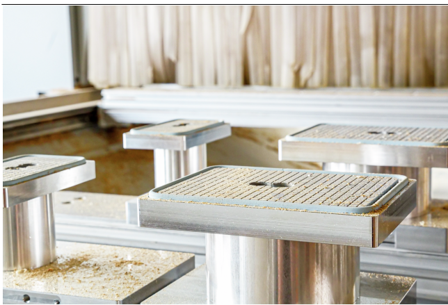
Blocksauger VCBL-K1-HD beim Aufspannen von Massivholz
