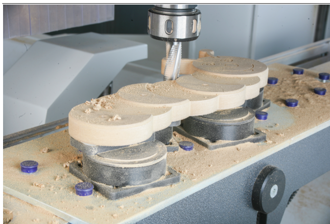
Adapter-Plates ISAP-K1 mit Mono-Bases und Sauger-Cups beim Aufspannen von gekrümmten Holzteilen
