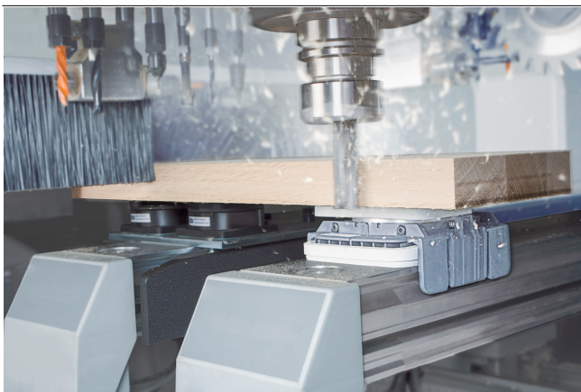
Blocksauger VCBL-K1 beim Aufspannen von Massivholz
